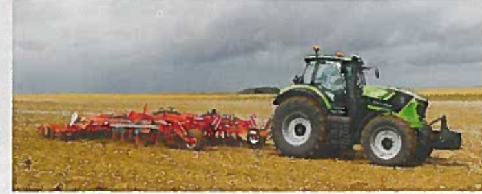
Le Série 8 repose sur un empattement de 2,92 m et peut être chaussé de pneumatiques arrière de taille 710/70 R42, soit 2,05 m de diamètre.
