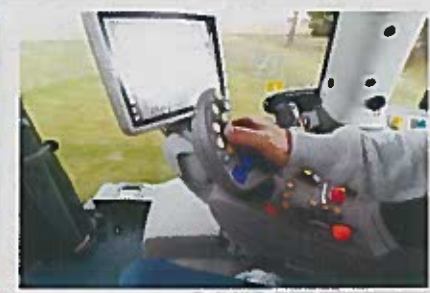
Sur la route, le chauffeur active un frein moteur sur la transmission en maintenant un appui long sur l'inverseur en marche arrière.
