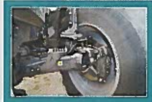
Les freins à disques à sec du 8280 TTV, montés sur le pont avant suspendu Dana, lui permettent de freiner, à nu, à une allure de 60 km/h.
