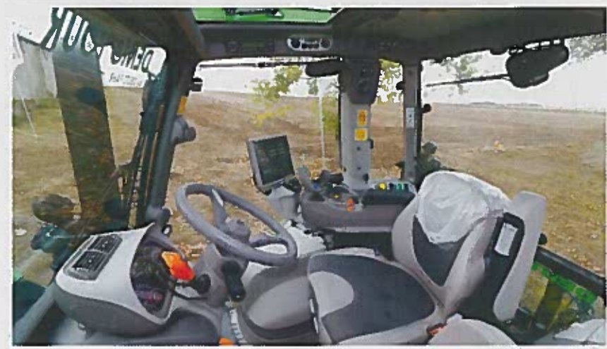
Les commandes sont regroupées sur l'accoudoir. Les réglages, à l'image de l'affectation des distributeurs, sont contrôlés depuis le terminal iMonitor 3 de 12".
