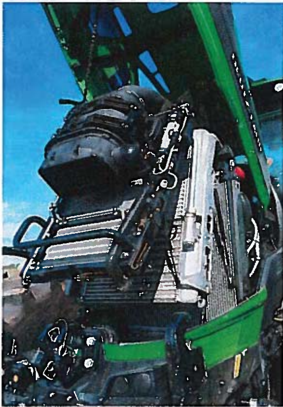
Le filtre à air et les radiateurs sont très accessibles.
