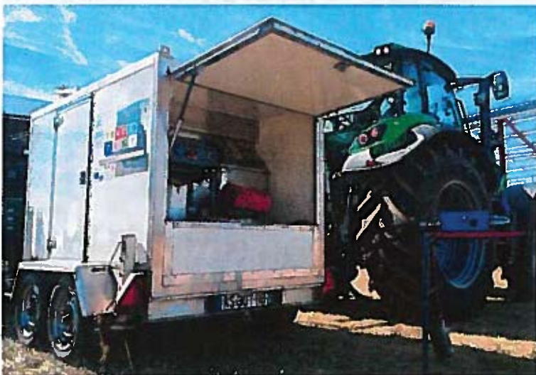
Accès des deux côtés au réservoir de GNR, et à droite pour l'AdBlue.
