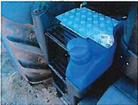
Accès des deux côtés au réservoir de GNR, et à droite pour l'AdBlue.
