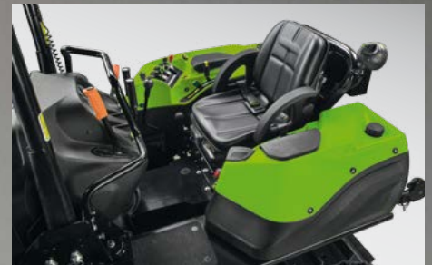
Die neue Fahrerplattform: Vibrationsfrei auf Silentblöcken gelagert und höchst ergonomisch.
