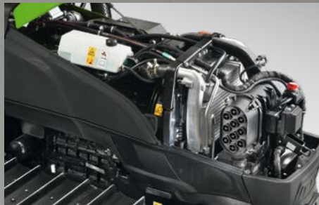
Kompakte Effizienz. Hubraumoptimierte FARMotion Motoren, Viscolüfter und PowerCore Luftfilter
