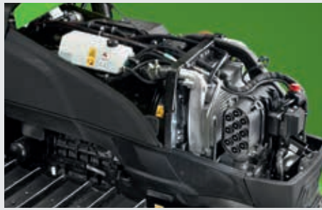
↑ Effizient und kompakt. FARMotion-Motoren mit optimiertem Hubraum, Viskolüfter und PowerCore-Luftfilter.
