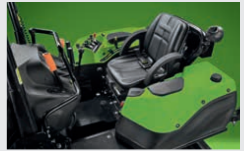
↑ Die neue Bedienplattform: schwingungsfrei dank Silent-Blocks und ergonomischer Gestaltung.
